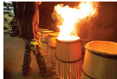
Slika 15. Prikaz elemenata pinterske tehnike (rezanje drvenih trupaca, prirodno sušenje duga i nagorevanje duga pri sklapanju burića)
